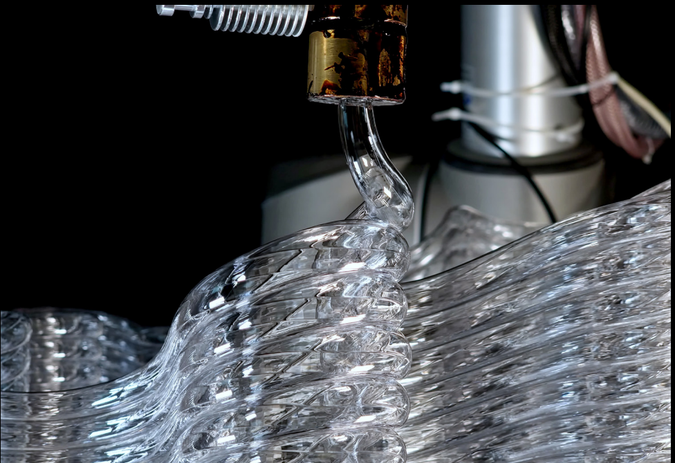
Blow Extrusion (FGF) Druckprozess mit einem Roboterarm
